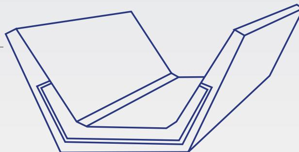
**Le système de connexion unique** d'Omnibeton avec des parties évidées et saillantes veille en effet à ce que les éléments s'emboîtent tant verticalement qu'horizontalement. **L'alignement** des éléments est facile, plus rapide et présente un meilleur rapport qualité/prix.
